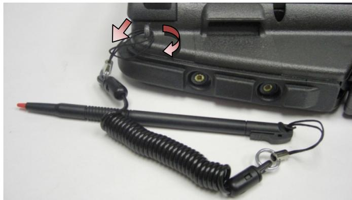
4. Quand le stylet et l'attache sont passés complètement dans la boucle, tirez sur le stylet pour fixer la boucle d'attache sur son ancrage.
