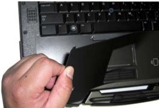
4. Après dépose de la moitié gauche du couvre-repose-mains, travaillez du milieu vers la droite.
