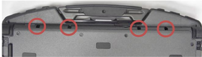
4. Placez une pointe plastique contre le logement de poignée sur le côté, enfoncez-le de 2,5 cm (1 pouce) et faites pivoter vers l'avant pour soulever légèrement le repose-mains.
