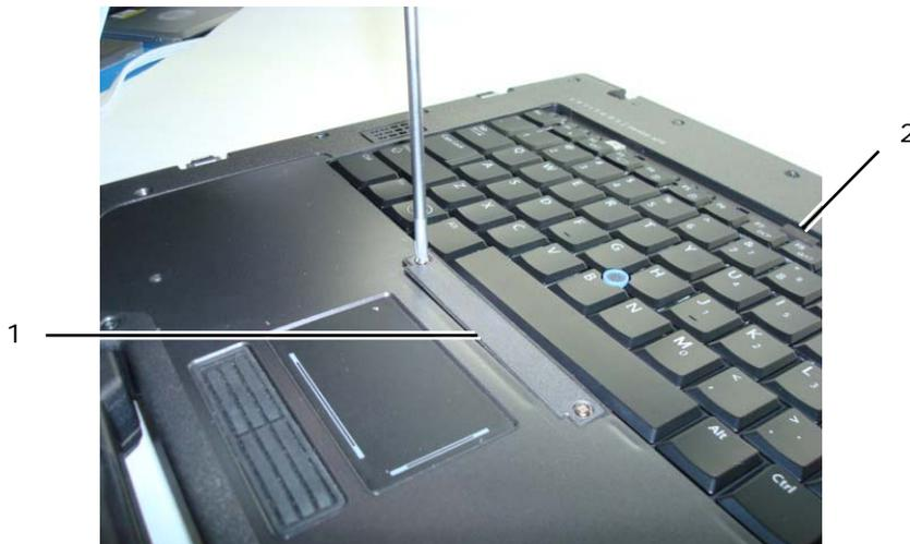
1 Support de clavier 2 Languette de traction
