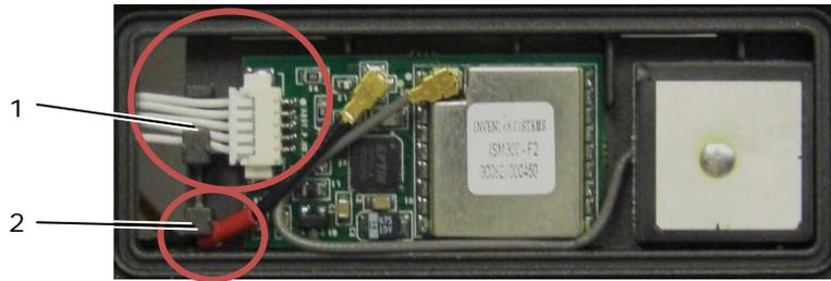
1 Guide de câble USB 2 Guide de câble d'antenne de transfert GPS
