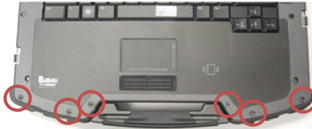
3. Retournez le système et déposez les quatre vis M2,5 x 8 mm de maintien du repose-mains.
